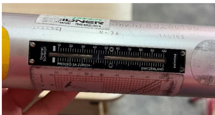
35 pav. Nustatyti denginio plokščių betono stipriai
