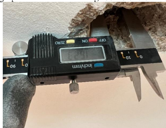
11 pav. Patikrintas plokščių armavimas
