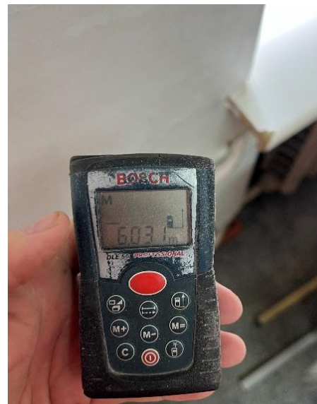
34 pav. Nustatytas denginio plokštės ilgis „šviesoje“
