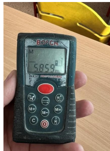
9 pav. Nustatytas denginio plokštės ilgis „šviesoje“
